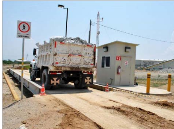
Figura 12. Proceso de pesaje de los camiones de mineral. (Mina Cuzcatlán - México)
