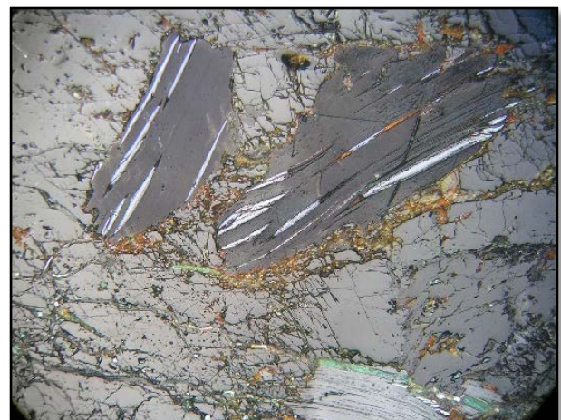
Ilustración 6: Sección pulida nícoles cruzados. Cristales de molibdenita en contraste de la matriz de ganga
