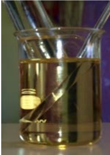
Figura 15. Ilusión óptica de invisibilidad debido a la igualdad de índices de refracción.
