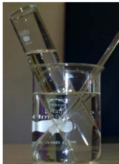
Figura 14. Ilusión óptica de quebramiento debido a la diferencia de índices de refracción
