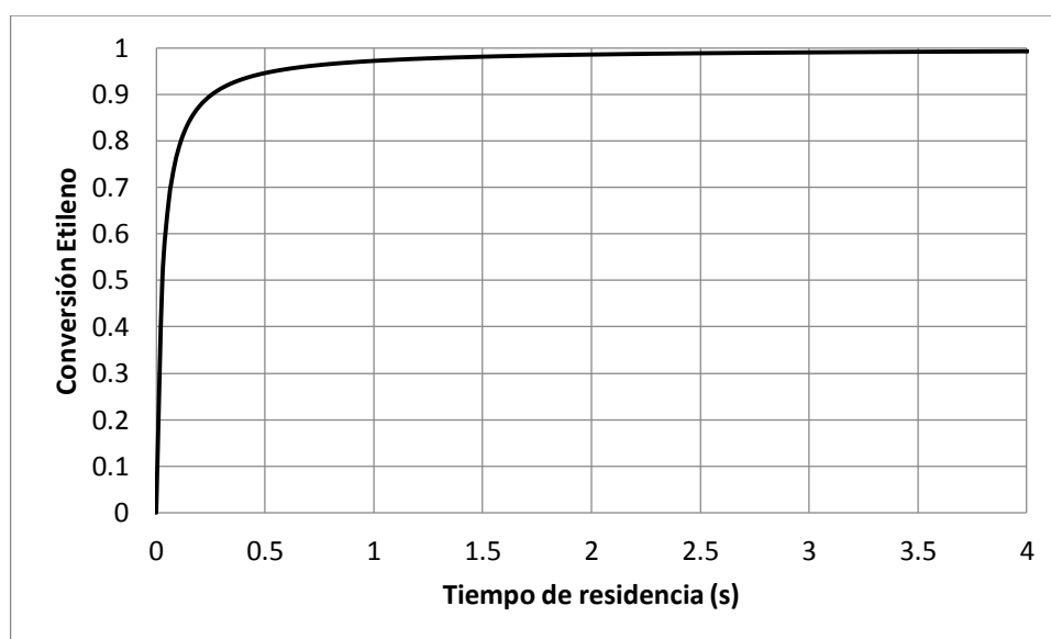
GRÁFICO 5 – 7. CONVERSIÓN DE ETILENO EN FUNCIÓN DEL TIEMPO DE RESIDENCIA EN EL REACTOR DE CLORACIÓN DIRECTA
